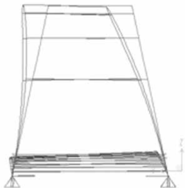
Fig. 10. Modo Fundamental de Vibración (Modo 1) – Vista transversal.
