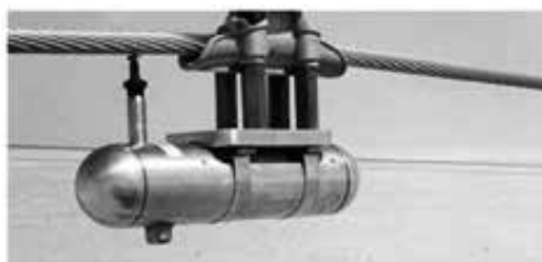
Figura 5 Medición de vibraciones eólicas
