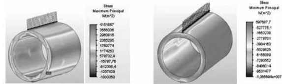
Figura 6: Tensiones máximas de tracción y compresión de THS, en N/m 2 . Software Algor.
