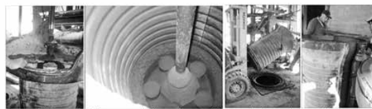
Figura 4. Proceso de llenado molde, traslado y desmolde.
