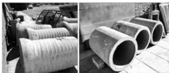
Figura 1. a) Tubos nervurados con encastre; b) tubos lisos sin encastre.
