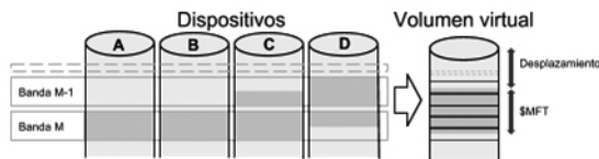
Ilustración 3 - Ejemplo de distribución de la MFT en los dispositivos físicos y el virtual.
