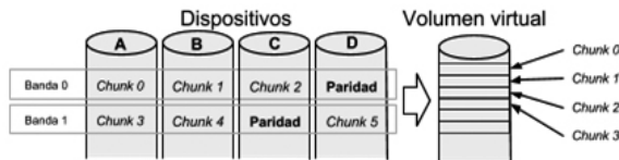
Ilustración 2 - RAID 5 de 4 discos (A a D) con paridad Left Asymmetric.
