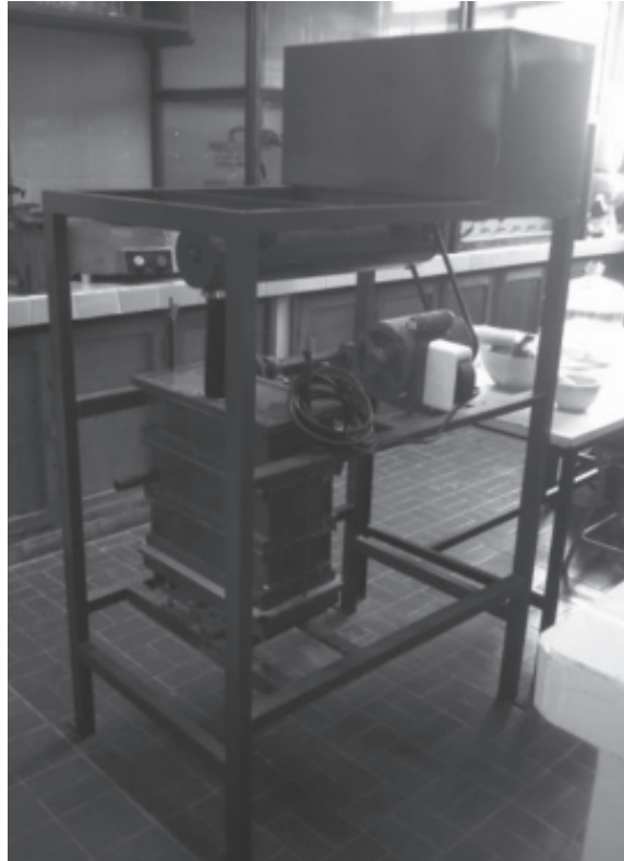
Figura 5. Escarificador de quinua.
