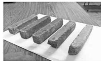
Figura 1. Ladrillos (probetas) de barro cocido a distintas temperaturas
