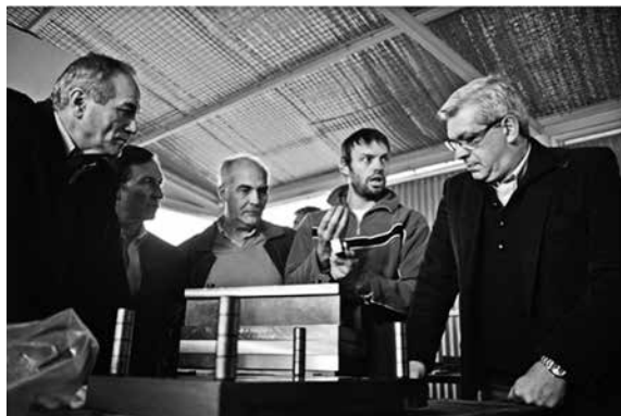
Figura 7. Matriz de inyección construida para la fabricación de patines.
