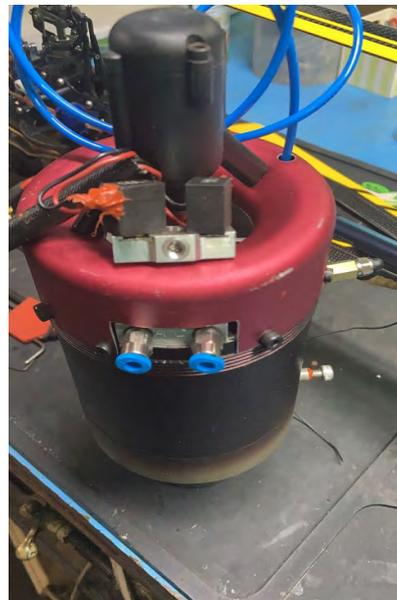
Figura 9: Nueva pieza con conexiones FESTO para la entrada de H<sub>2</sub> a la turbina.
