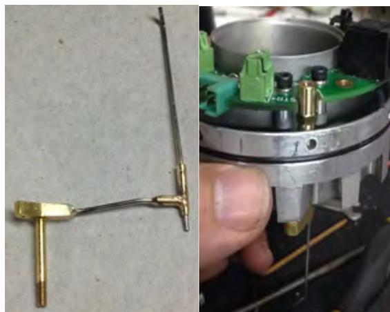
**Figura 4: Nueva cañería de lubricación y montaje.**
