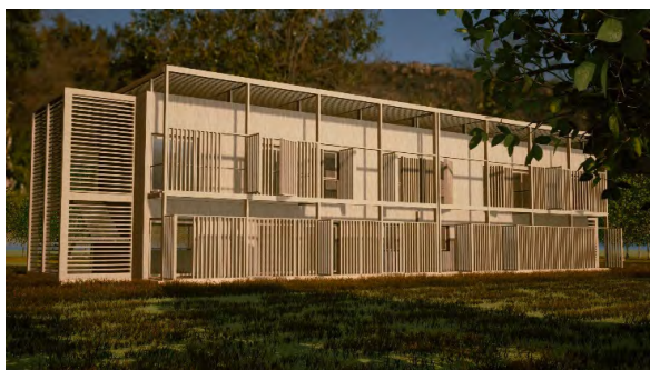
Figura 5: Modelo 3D para simulación del caso 1: parasoles abiertos.
