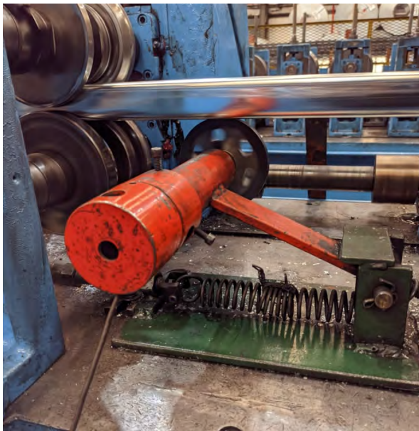
Figura 6: Sistema automatizado de medición de perfiles.
