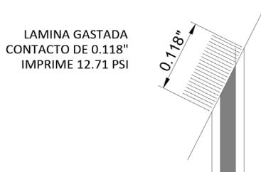
Figura 6: Presión que ejerce el espesor de contacto de una lámina gastada totalmente.
